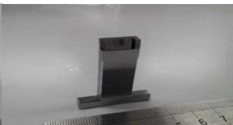
キャブスライドコアピン 材質:STAVAX 硬度:HRC52 加工:平面研磨、放電加工 形状公差:±0.01
