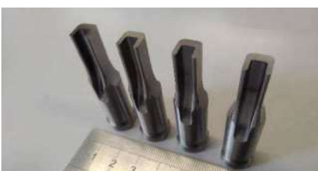
特注シャンク異形状パンチ 材質:SKD11 硬度:HRC60~63 加工:円筒研磨、プロファイル 形状公差:±0.01
