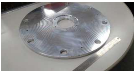
テーブル φ500 材質:A5052 加工:マシニング 平面度0.1以下
