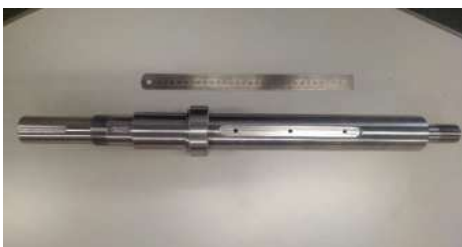
シャフト 材質:S45C 加工:旋盤、円筒研磨、フライス
