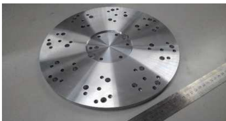
ベース φ290 材質:A5052 加工:マシニング 平面度、平行度0.1以下
