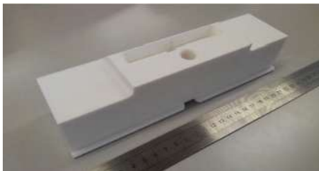
樹脂加工 材質:POM 加工:マシニング
