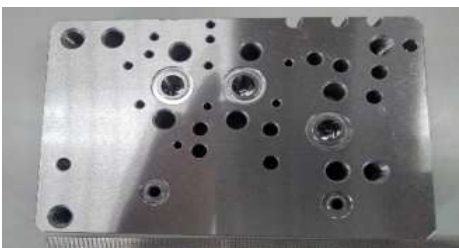
冷却ユニット 材質:STAVAX 硬度:無し 加工:マシニング、平面研磨、横穴ガンドリル
