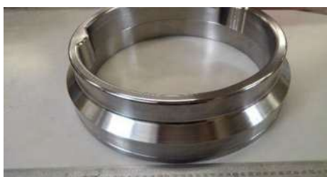
大型丸パンチ(外径φ390) 材質:DC53 硬度:HRC60~63 加工:旋盤加工、エンドミル加工 刃先公差:0、+0.02
