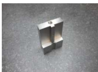
NC放電加工品 サイズ: 13.0 \times 30.0 \times 40.0 材質: スチール
