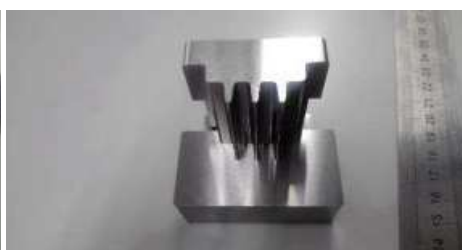
異形状パンチ、ダイ 材質:DC53 硬度:HRC60~63 加工:平面研磨、ワイヤーカット、 プロファイル 刃先公差:±0.01 パンチとダイのクリアランス片側0.05
