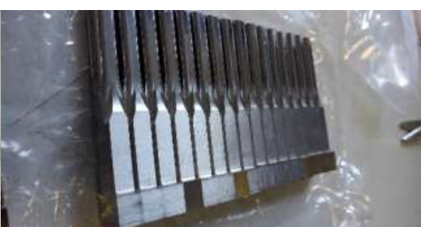
特注異形状ブロックパンチ 材質:DC53 硬度:HRC58~60 加工:平面研磨、プロファイル 刃先公差:±0.01
