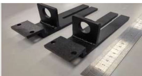
溶接ブラケット 材質:SPCC 加工:溶接、フライス 黒染め
