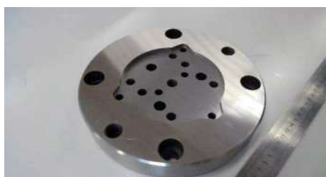
異形状パンチ、ダイ 材質:DC53 硬度:HRC60~63 加工:平面研磨、ワイヤーカット 刃先公差:±0.01 パンチとダイのクリアランス片側0.06
