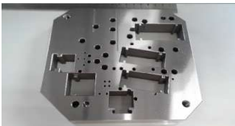
入れ子保持板 材質:HPM1 硬度:HRC40 加工:平面研磨、ワイヤーカット、フライス 形状公差:±0.01
