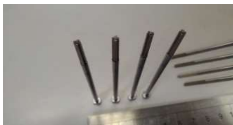
先端異形状コアピン(十字形状) 材質:SKH51 硬度:HRC61~64 加工:円筒研磨、放電加工 先端公差:±0.01 シャック径公差:0, +0.005
