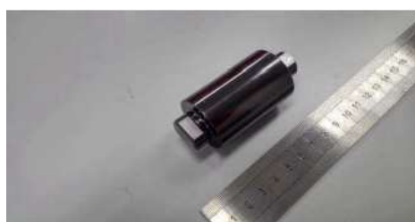
特注フランジパンチ 材質:SKD11 硬度:HRC60~63 加工:旋盤、円筒研磨、成型研磨、低温TiCN 公差:±0.01
