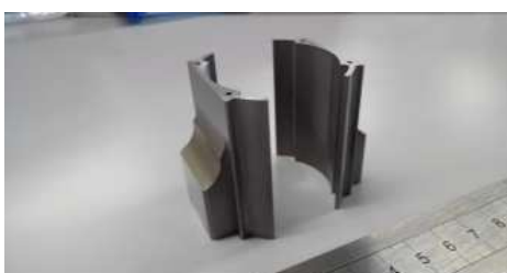
特注異形状パンチ 材質:DC53 硬度:HRC58~60 加工:ワイヤーカット、放電加工 形状公差:±0.01
