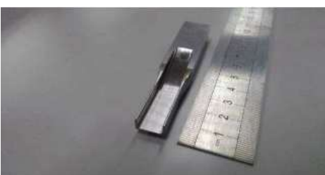
特注シャンク異形状ブロックパンチ 材質:DC53 硬度:HRC58~60 加工:フライス、平面研削、プロファイル 形状公差:±0.01
