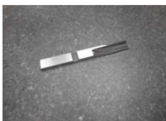
切り上げパンチ サイズ: 3.0 \times 6.0 \times 60.0 材質: 超硬
