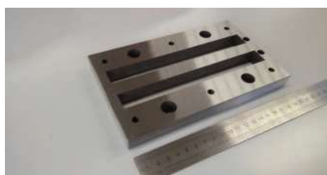
特注プレート(ストリップ) 材質:SKS3 硬度:HRC58~60 加工:マシニング、ワイヤーカット 公差:±0.01
